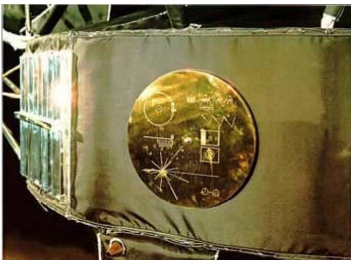
Figure 38 : Disque de cuivre plaqué or des sondes Voyager 1 et 2
