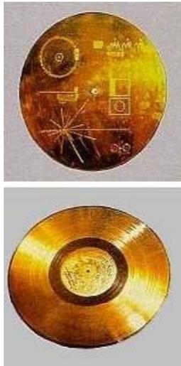
**Figure 39 : Disque de cuivre plaqué or des sondes Voyager 1 et 2**
